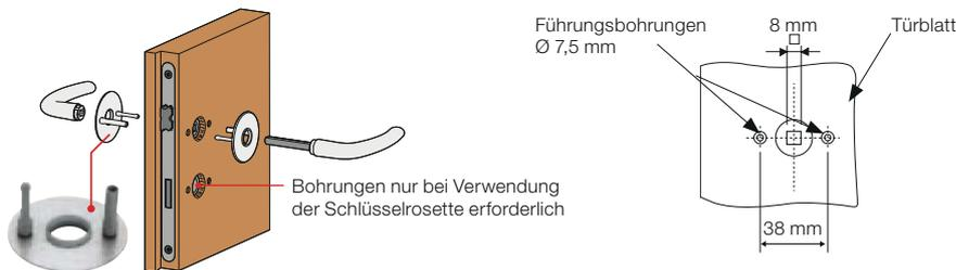
Die Griffrosetten E847N, E848N und E849N mit durchgehenden Stütznocken können optional mit einer Rückholfeder ausgestattet werden. Türvorbereitung siehe S. 26.
