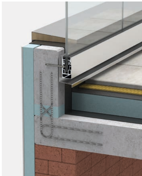
(C) Außenanwendung: Beispiel Balkon-Attika, gedämmt, Profil innen exterior application: example balcony attica, insulated, profile inside
