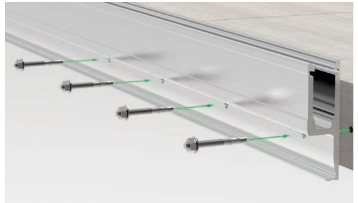
1. Profil anschrauben | mount the profile
