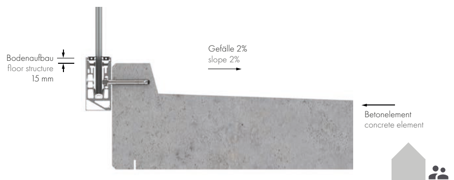
(B) Außenanwendung: Beispiel Balkon mit Betonelementen, Gefälle nach innen exterior application: example balcony with concrete elements, slope inwards
