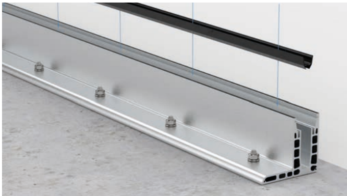
2. Unteres Verglasungsprofil einsetzen (im Außenbereich an den bauseitig hinzugefügten Entwässerungsbohrungen aussparen) Insert lower glazing profile (for outdoor usage, blank out at the drainage holes)
