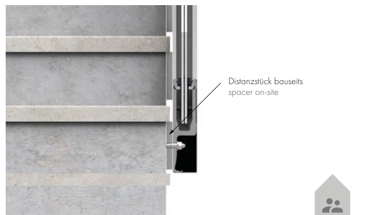
(E) Innenanwendung: Beispiel Treppe mit Überstandsstufen interior application: example staircase with overhang steps
