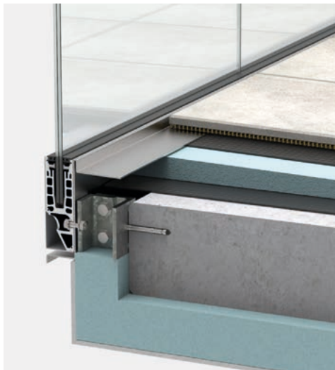
(D) Außenanwendung: Beispiel Balkon mit Betonelementen gedämmt - Gefälle nach innen exterior application: example balcony insulated with concrete elements - slope inwards
