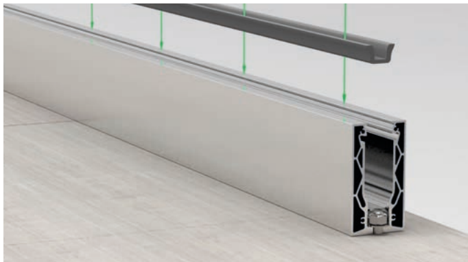
2. Unteres Verglasungsprofil einsetzen (im Außenbereich an den Entwässerungsbohrungen aussparen) insert lower glazing profile (for outdoor usage, blank out at the drain holes)
